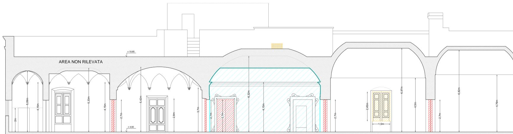
SEZIONE A-A (PROGETTO) - scala 1:50
