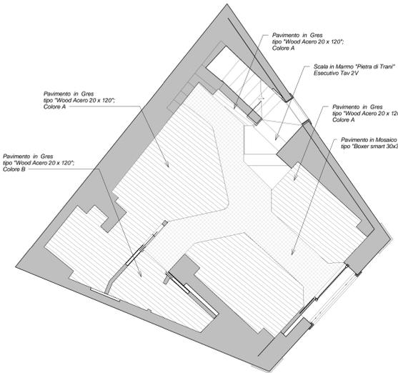
PIANTA PAVIMENTAZIONE PIANO TERRA
